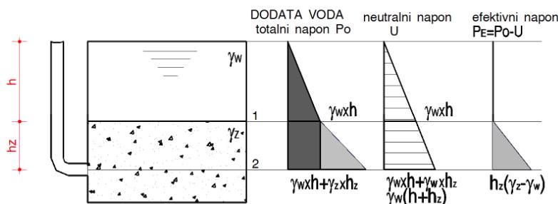
Napon  $\gamma_w * h$  naziva se neutralni napon ( $U$ ) i on ne izaziva sleganje niti povećanje smičuće čvrstoće tla. Prenosi se porama tla u svim pravcima.
