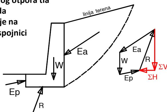
Sile koje deluju na masivnu potpornu konstrukciju
