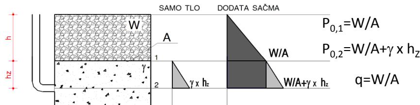
Opterećenje sačmom izaziva sleganje tla, smanjuje poroznost i povećava smičuću otpornost tla
