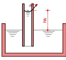
Kapilarnost: Voda se uz usku cev potopljenu u vodu penje uz cev do visine kapilarnog penjanja  $h_k$
