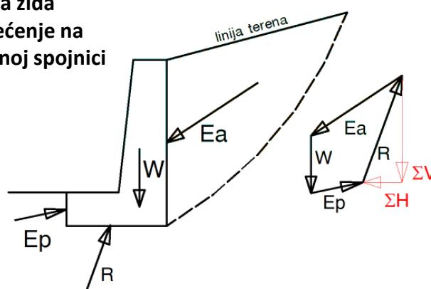
Sile koje deluju na masivnu potpornu konstrukciju
