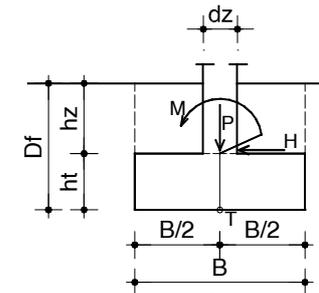
Redukcija sila na težište temeljne spojnice
