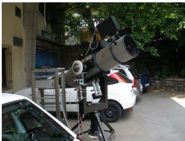
Sl.2. Instrument (Big sky laser) za atmosferska ispitivanja
